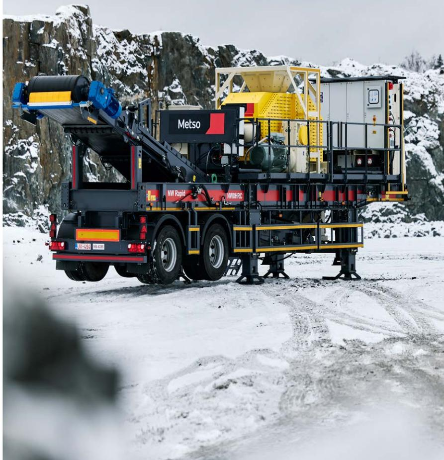
美卓HRC™ 8高压辊磨机是机制砂生产的理想选择，具有能耗低、磨耗件消耗低的特点。
