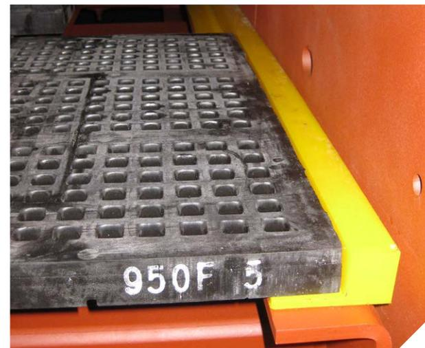
LS-S-290-500边筛板和搭配边角条完成正确的安装
