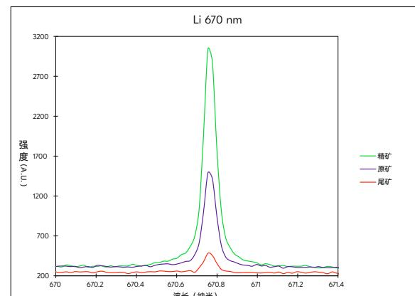
使用 Courier 8X 测量的锂辉石原矿、精矿和尾矿样品
