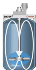
低切变 OKTOP®反应器专为低切变应用场合而设计。该反应器能获得均衡的能量分布和高效轴向流。自支撑的结构增加了抗疲劳性能。
