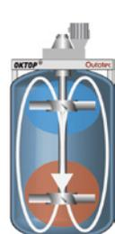
垂直液流OKTOP®反应器专为受颗粒扩散速率限制的浸出工艺而设计。它可以实现最大搅拌功率和优异的气-固传质，以及出色的固相悬浮特性。
