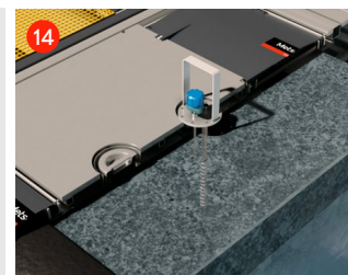
DispersionSense™ 持续测量有机相/混合相、混合相/水相界面状态。
