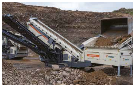
大型上料箱满足闭路回路操作要求
