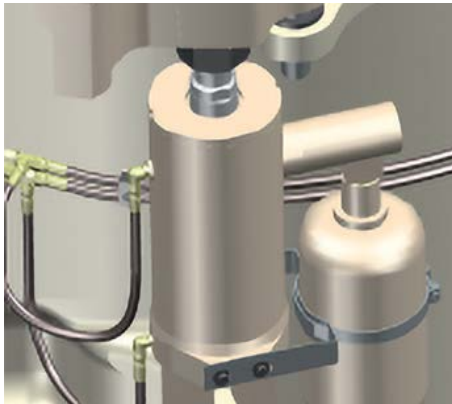
过铁释放缸连接的蓄能器，过载时可立即恢复生产。
